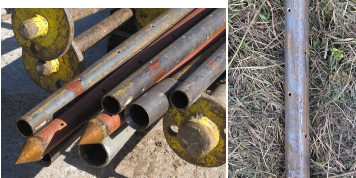
Figur 7-5. 2-tums (5 cm) stålrör med spetsade ändar för att trycktas som vertikala gasbrunnar (Serti, 2010).
