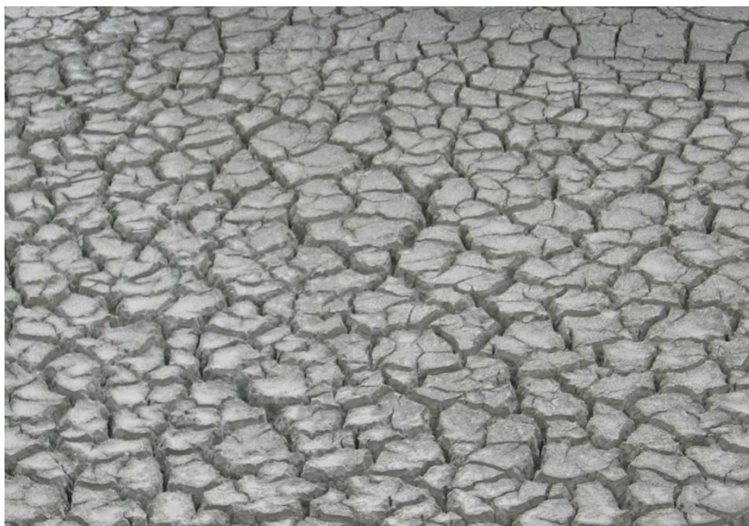
Figur 10-9. Illustration av anlagd lera att tjäna som botten tätning men som har torkat ut (Serti, 2004).
