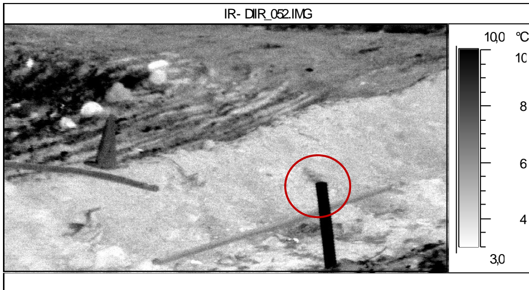
Figur 6-4. Resultat med värmekamera. Gasläckage ur rör på Filbornadeponin i Helsingborg (SGC Rapport 203, 2009).
