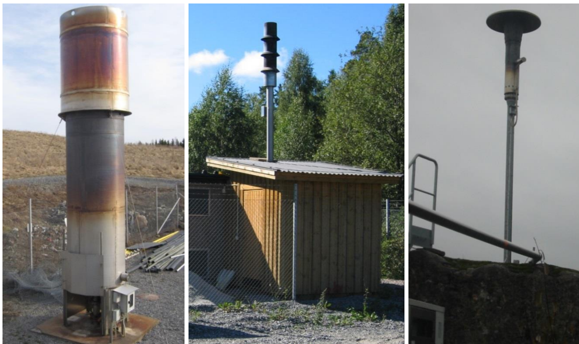
Figur 8-6. Olika typer av facklor (Vänster: Gryta, Västerås. Mitt: Högbytorp, Upplands-Bro. Vänster: Tveta, Södertälje) (Serti, 2012, 2005, 2003).
