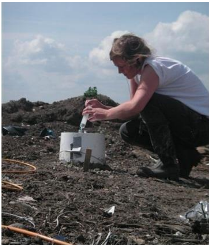
Figur 6-7. Provtagning av luft ur statisk kammare med hjälp av en spruta.
