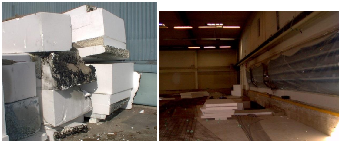
Figur 10-4. Till vänster: brandskadade frigoelitblock. Till höger: eldslågor som svedde väggar och kablage in mot kontorsdelen (Serti, 2003).
