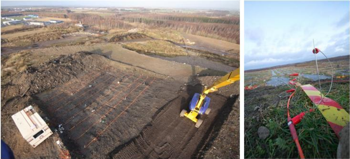
Figur 6-5. Uppställning för resistivetsmätningar i 3D. De rödgula plastbanden visar linjerna för resistivetsmätningarna.
